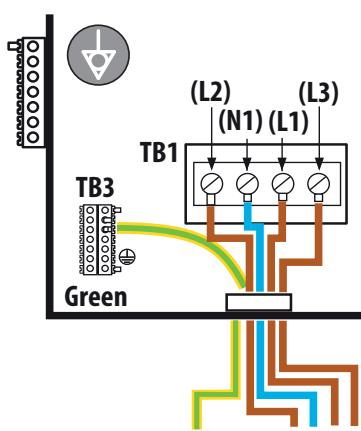
dimensionare in base all'assorbimento di corrente (massimo o alternativo) / size based on current absorption (maximum or alternative)
